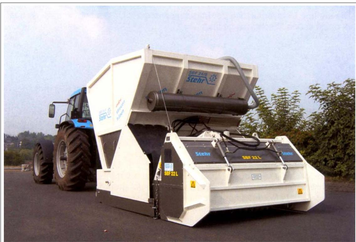
Bild 11.5: Kombinierte Verteil- und Fräseinrichtung
