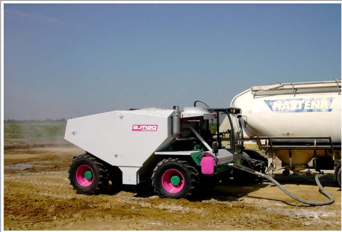
**Bild 11.2: Kalkübergabe von Silofahrzeug in den Verteiler**
